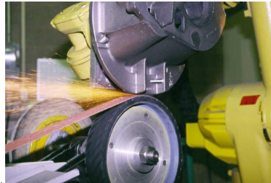
图 10-14 机械手打磨铸件
