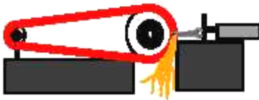
图 10-8 高压强力快速送进打磨示意图 10-
